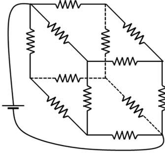
1.- Doce resistencias de  $1\Omega$  están dispuestas en los lados de un cubo tal como muestra la figura. Determine la resistencia equivalente entre vértices opuestos. (Solución:  $5/6\Omega$ )
