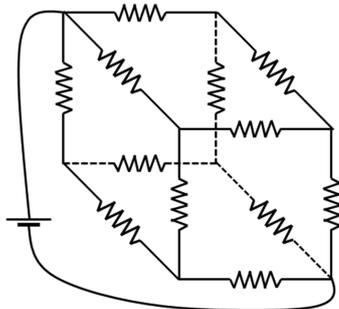
1.- Doce resistencias de  $1\Omega$  están dispuestas en los lados de un cubo tal como muestra la figura. Determine la resistencia equivalente entre vértices opuestos. (Solución:  $5/6\Omega$ )
